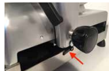
Leva di sgancio carrello per utilizzo in manuale Lever to start the manual advance
