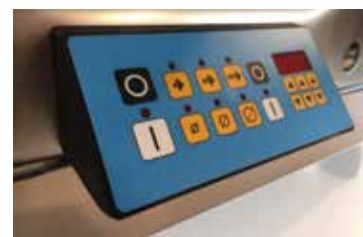
Pannello digitale con possibilità di 3 velocità e 3 corse (versione cinghia) Digital control panel with 3 speeds and 3 strokes (version of belt)
